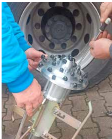
Głowica do czyszczenia kanalizacji z twar- dych osadów oraz korzeni (2023 r.). Koszt zakupu ok. 14 tys. zł
